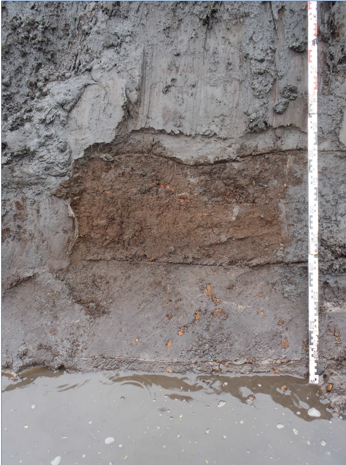
Figuur 5. De bodemopbouw in het noordelijke deel van deelgebied C, in dit geval profiel 1. Onder het veen bevindt zich grijs dekzand, waarin geen sprake is van bodemvorming.
